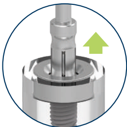
Paso 1: vista conexión llave de inserción IDrive
