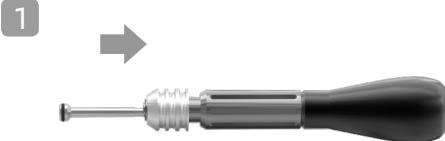
**1 - EN** PULL BACK THE GREY METAL RING TO REMOVE THE INSERTION KEY
