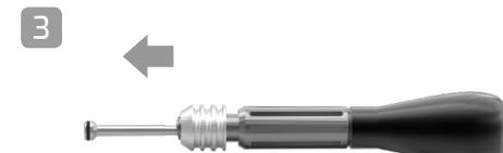
**3 - EN** RELEASE THE GREY METAL RING AFTER INTRODUCING THE INSERTION KEY
