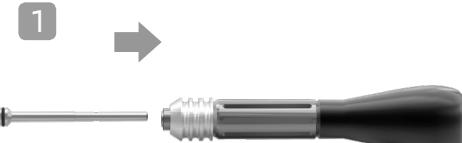
**1 - EN** PULL BACK THE GREY METAL RING BEFORE INTRODUCING THE INSERTION KEY
